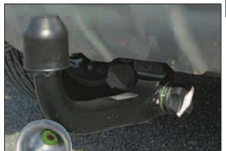
RDSO : rotule démontable sans outil.
