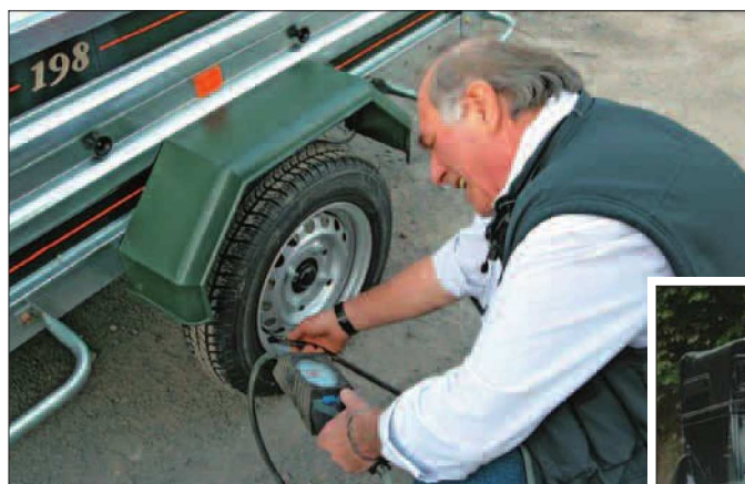
En solo comme en traction, il est impératif d'avoir des pneus bien gonflés, selon les préconisations du constructeur de la voiture et de celui de la remorque.
