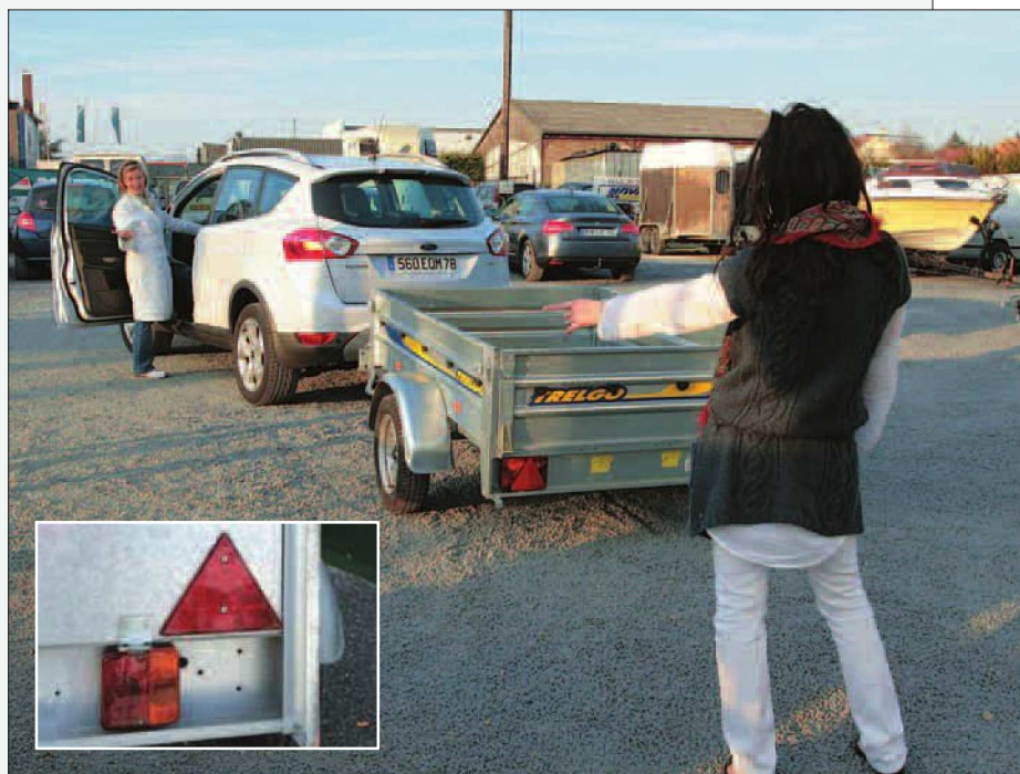
Avant de prendre la route, il est important de vérifier le bon fonctionnement des feux de signalisation de la remorque.
